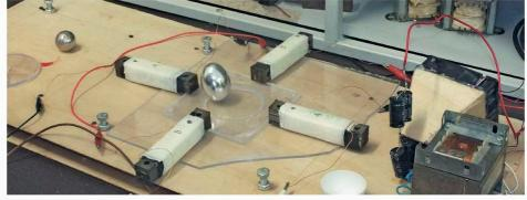
mierini magnetici abbiamo costruito il nucleo e su di esso abbiamo avvolto a mano del filo di rame smaltato, realizzando così 4 bobine, con 600 spire ciascuna . Gli avvolgimenti sono collegati in serie a due a due per realizzare due coppie polari ed un condensatore è in serie ad una coppia per sfasare le correnti ed ottenere un campo rotante.
