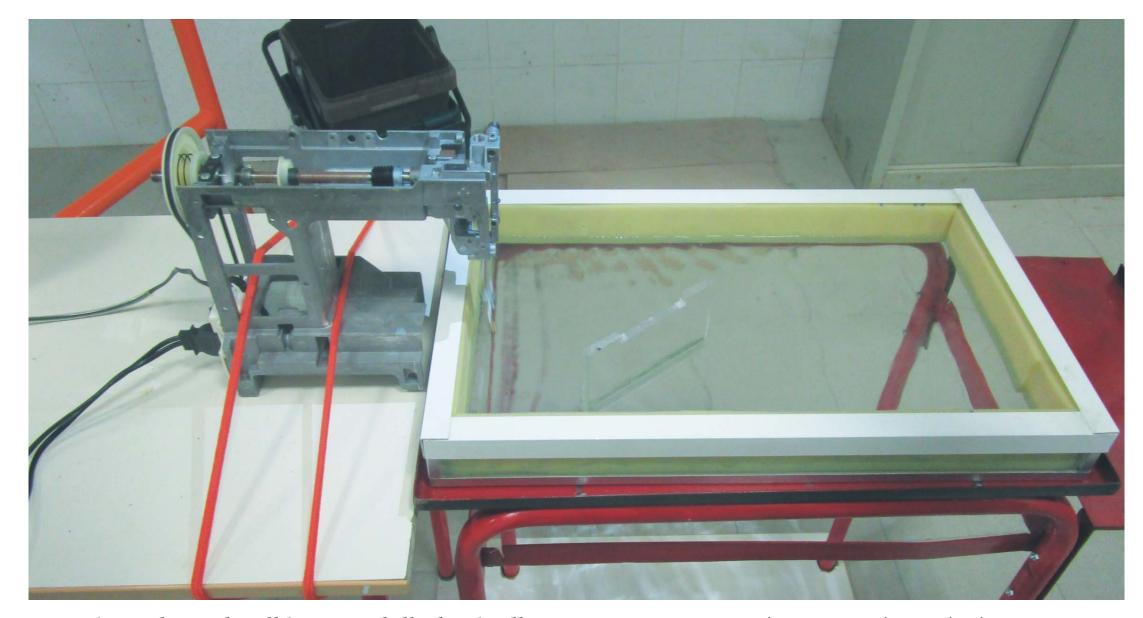
Generiamo le onde all'interno della bacinella e poniamo sul loro passaggio una barriera, con un certo angolo rispetto alla direzione in cui si propagano. Le onde così subiranno una deviazione: l'angolo delle onde incidenti rispetto alla retta perpendicolare alla barriera è uguale al corrispondente angolo delle onde riflesse. Questo fenomeno si chiama riflessione.
