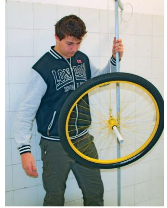
messa in rotazione, il mozzo rimarrà lungo l'asse intorno a cui gira la ruota. La direzione del momento angolare è ortogonale al piano di rotazione: per la sua conservazione la ruota non può ricadere.
